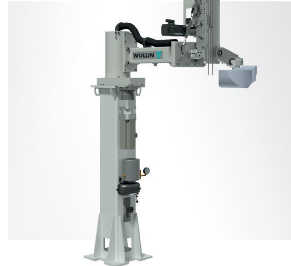
Die Wollin Metalldosiergeräte **WL 1 - 4** wurden speziell zur automatischen Metallbeschickung von Druckgießmaschinen sowie für Kokillengießmaschinen bis zu 80 kg Schöpfgewicht entwickelt. Der platzsparende Anbau erfolgt auf einem separaten Montageständer, dadurch sind keine Änderungen an Druckgieß- oder Formsprühmaschine notwendig.
