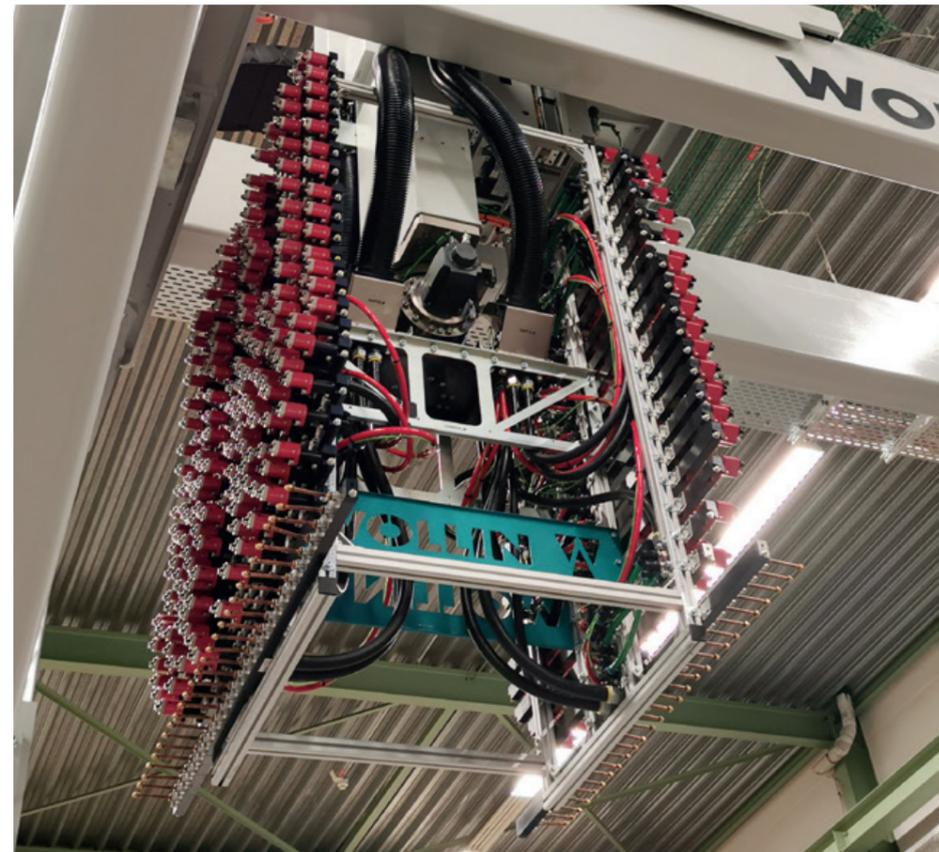
Maskensprühwerkzeug für Batteriegehäuse
