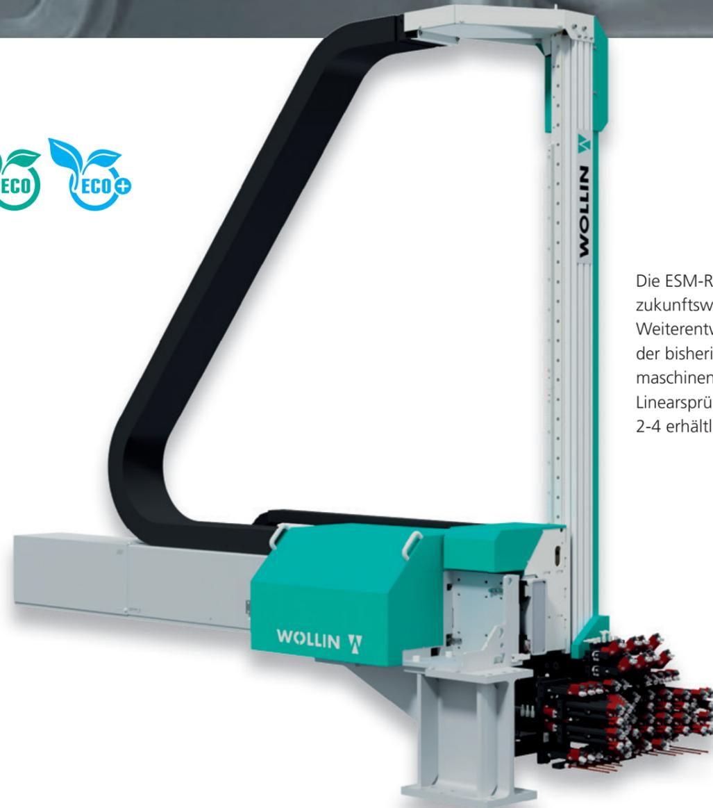
Die ESM-Reihe ist die zukunftsweisende Weiterentwicklung der bisherigen Sprühmaschinen. Es sind die Linearsprühgeräte ESM 2-4 erhältlich.
